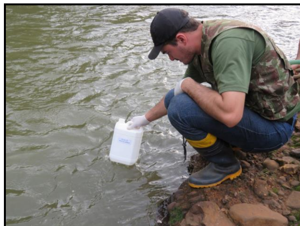
Figura 6.22 – Procedimento de coleta de amostra para análises físico-químicas.
