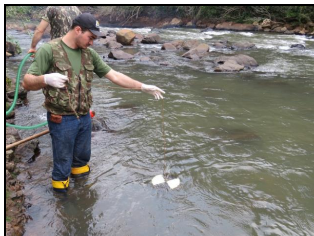
Figura 6.24 – Mensuração da profundidade e transparência do local de coleta.
