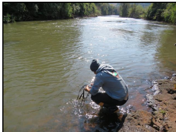
Figura 6.20 – Mensuração dos níveis de oxigênio dissolvido, saturado e temperatura da água.
