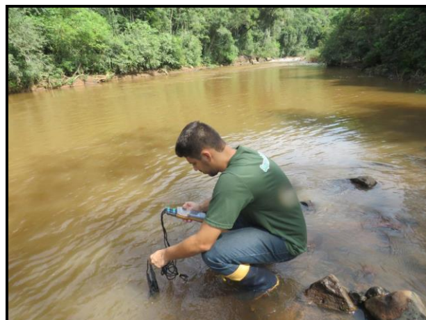
Figura 6.26 – Mensuração dos níveis de oxigênio dissolvido, saturado e temperatura da água.
