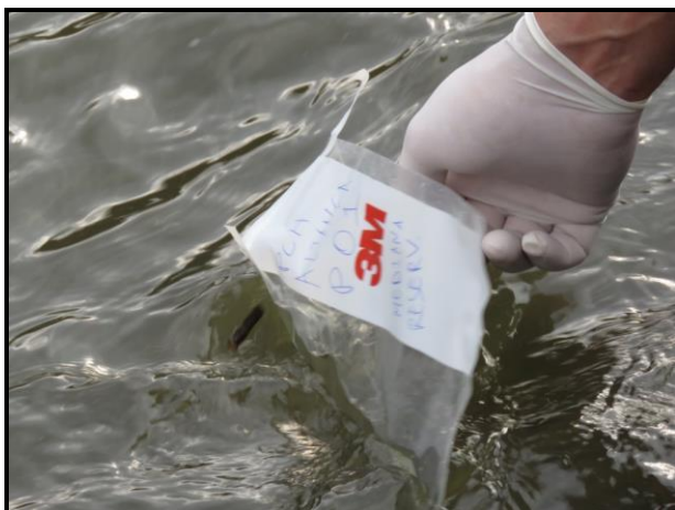
Figura 6.21 – Procedimento de coleta de amostra para análises microbiológicas.
