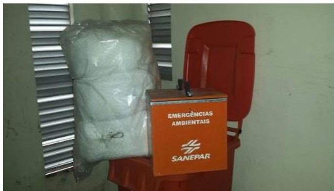
Figura 2 – Barreiras de absorção, caixa de coleta e contêiner para armazenamento
